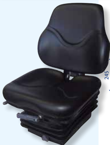
405.00.79.03 SEDILE IN SKAY A BASE PIANA CON GUIDE E MOLLEGGIO MECCANICO M200 REGOLAZIONE PESO: DA 50 A 120 KG
