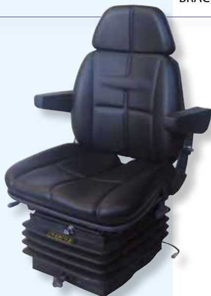
405.00.95.17 SEDILE IN SKAY BASE PIANA CON GUIDE E MOLLEGGIO AD ARIA M98 BRACCIOLI FISSI E PROLUNGA SCHIENALE, REGOLAZIONE PESO: DA 50 A 120 KG
