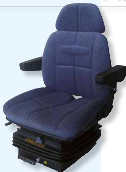
405.00.95.16 SEDILE IN STOFFA A BASE PIANA CON GUIDE E MOLLEGGIO MECCANICO M293 BRACCIOLI FISSI E PROLUNGA SCHIENALE, REGOLAZIONE PESO: DA 50 A 120 KG
