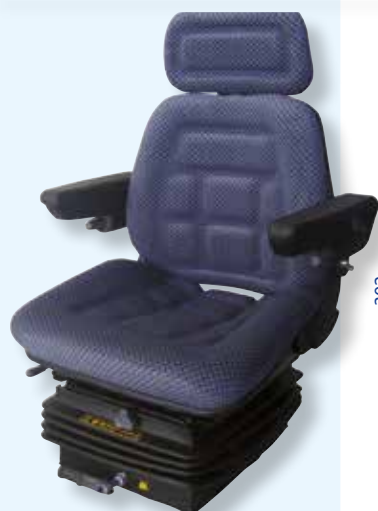
405.00.90 SEDILE IN STOFFA A BASE PIANA CON GUIDE E MOLLEGGIO MECCANICO M293 , REGOLAZIONE LOMBARE, BRACCIOLI REGOLABILI E PROLUNGA SCHIENALE REGOLAZIONE PESO KG 50/130
